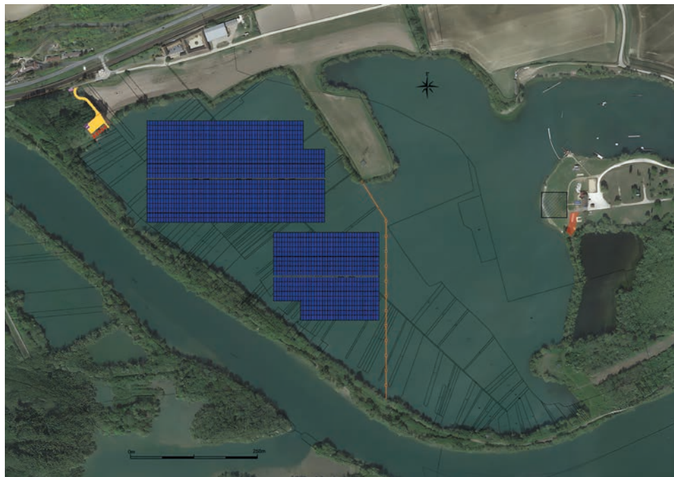
Projet photovoltaïque flottant La Grande Paroisse-8,3 ha de panneaux pour une puissance de 19,5 MWc
